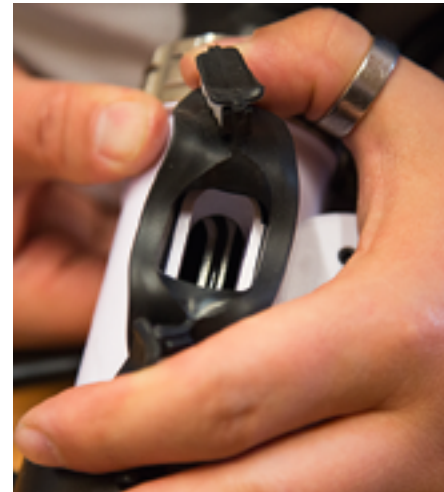
Beim Öffnen des Loops am Mundstück wechselt man dank des verbauten BOVs direkt auf das Diluent-Gas und somit ins offene System.
