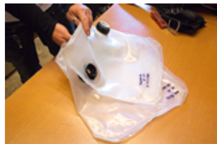
Die zwischen Diluent-Flasche und Kalkbehälter liegenden Gegenlungen sind ineinander verbaut und haben ein Volumen von 4,5 Litern.
