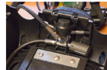
Die erste Stufe ist eine Adaption für den Explorer. Hier findet sich auch der Sender, der den Flaschendruck an den Rechner schickt.
