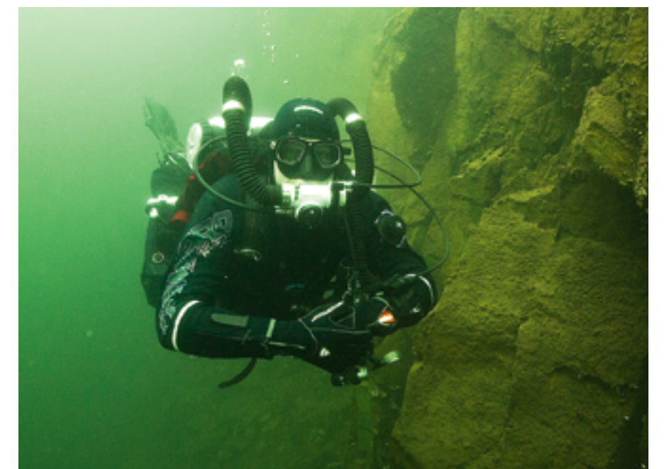
So kompakt die Einheit an Land ist, so kompakt taucht sie sich auch. Lagewechsel sind ein Kinderspiel. Wie üblich bei Gegenlungen auf dem Rücken, wird man nur in Rückenlage »aufgeblasen«.
