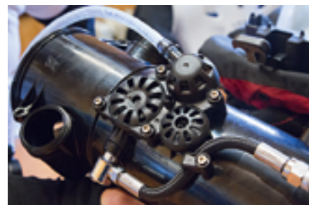
Hier erfolgt die bedarfsgesteuerte Nitrox-Einspeisung ins System, wie auch die Abgabe des überschüssigen Gases an die Umgebung.
